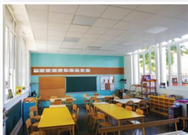
Les travaux de rénovation de la classe se sont terminés au mois d'août : isolation intérieure des murs et du faux plafond, celui-ci également abaissé. L'éclairage est remplacé par des LED, les anciens
